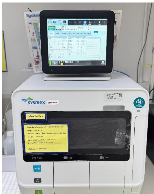
เครื่องตรวจวิเคราะห์ความสมบูรณ์ของเม็ดเลือดอัตโนมัติ (CBC)
